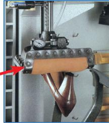
**Das Luftkissen** sorgt für optimale Druckverteilung und sichere Anpassung selbst bei problematischen Materialien und in verklebungstechnisch schwierigen Zonen. Das separate Presskissen-Manometer zeigt den exakten Druck im Kissen an. Autom. Zahnstangenverriegelung: Nach Absenken des Presskissens verriegelt eine pneumatische Sperrklinke automatisch die Zylinder-Druckstange.
